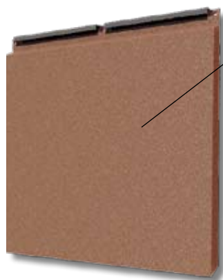
Фасадная кассета МП 2005 глубина кассеты 25 мм ширина руста между кассетами 30 мм
