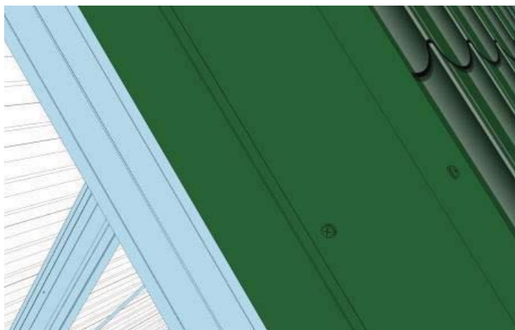
4.3.3 После крепления фасонного изделия Ф1 на торцы кровли монтируем торцевые планки. Крепим их через 500-600мм саморезами d4.8x28 мм (сбоку) и d4.8x80мм (сверху). Нахлест планок – 50 мм, при необходимости планки подрезаем.
