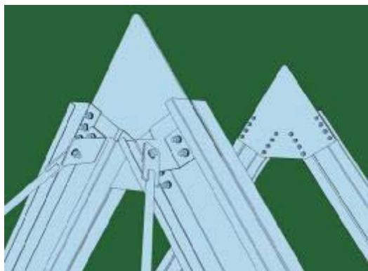
3.13.2 Стойки второго этажа связываются между собой соединительными элементами поз.№15.
