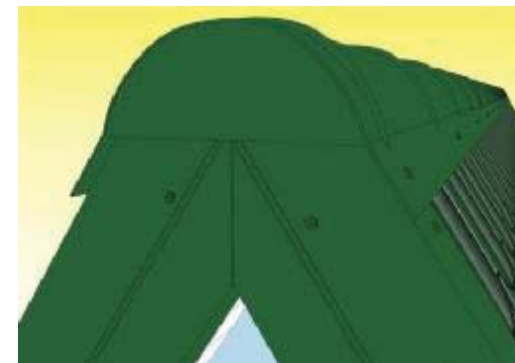
4.3.4 Крепим торцевые заглушки на конёк саморезами d4.8x28 мм.
